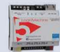
• LM5p2-KC 自身兼容KNX和CAN 于一体的LM5网关
