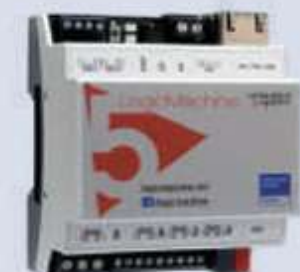
• LM5p-DR 集DALI于一体的 二合一智慧网关 远程KNX总线控制
