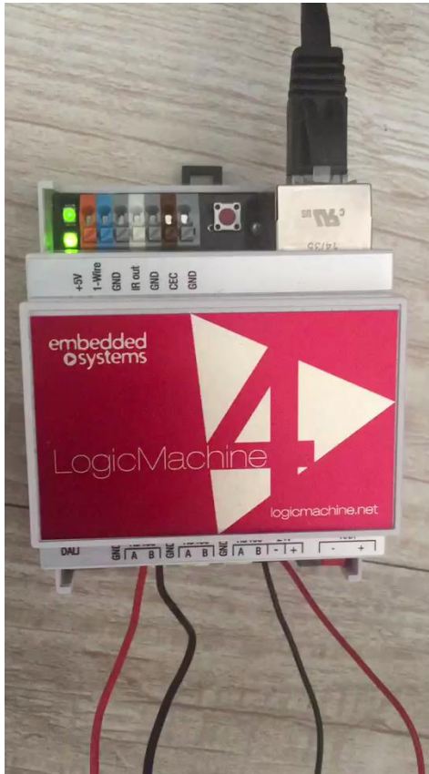
正常运行，设备闪绿灯
