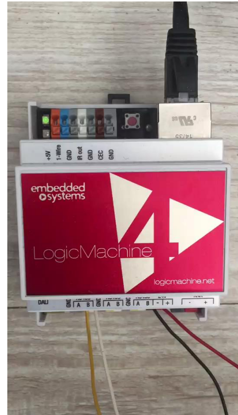
确认设备，设备红绿交错闪烁；确认完毕后，再按一次恢复正常运行
